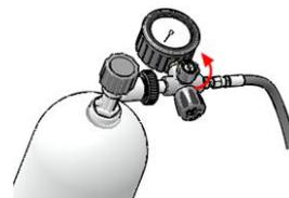
10. 旋转取出气瓶上的充气阀，拿掉气瓶。
