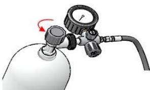
7. 当达到指定工作压力后压缩机自动停机，关闭瓶阀，关闭充气阀。
